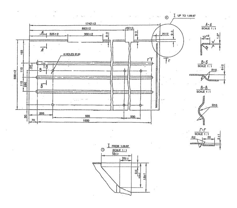
FIG: FRONT LEFT FENDER TO DRG.NO.172.04.593.
